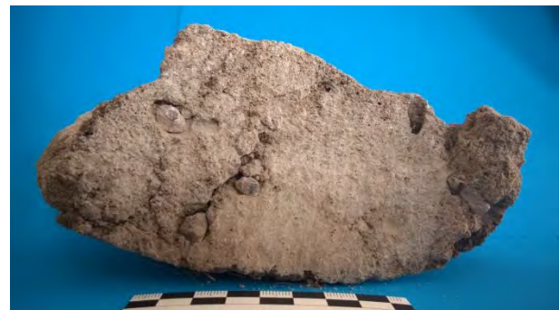
Abb. 2 Kalkmörteloberfläche mit Kalksinterschicht
