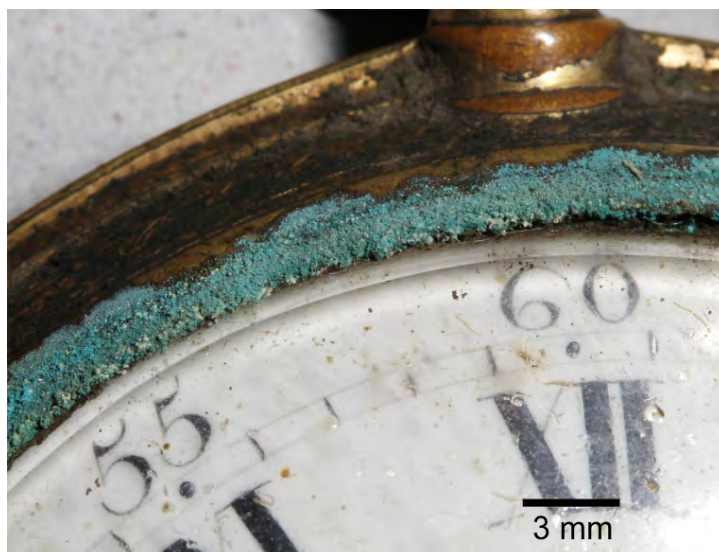
Abb. 1: Taschenuhr, Tröpfchen auf der Innenseite des Deckglases, weiße und grüne Korrosionsprodukte an der Lünette. Museum für Hamburgische Geschichte, Inv. Nr. 1899.101b.
